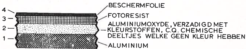
FIG. 20 DOORSNEDE EN OPBOUW VAN EEN POLYCHROMALPLAAT
